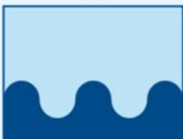
2. Die im Alltag beanspruchte Oberfläche des Autolackes bekommt mikroskopisch feine Vertiefungen. Die Reflektionsfähigkeit des Lackes nimmt ab und somit auch der Glanz.
