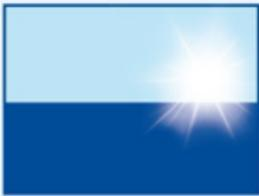
1. Ein neuer Autolack weist im Querschnitt eine glatte Oberfläche auf. Licht kann maximal reflektieren. Das Auto glänzt.
